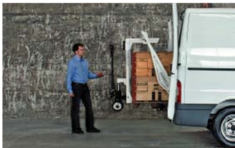
2. Mittels Knopfdruck auf das Steuergerät wird der eingehängte HUBRolli mit dem ganzen Ladegut eingeladen. 2. Par simple pression sur le bouton de commande, le HUBRolli est accroché et chargé avec la marchandise.
