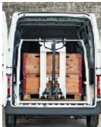
2. Mittels Knopfdruck auf das Steuergerät wird der eingehängte HUBRolli mit dem ganzen Ladegut eingeladen. 2. Par simple pression sur le bouton de commande, le HUBRolli est accroché et chargé avec la marchandise.
