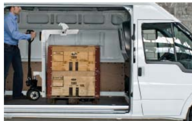
3. Im Laderaum wird der HUBRolli ausgehängt und das Ladegut an der entsprechenden Stelle platziert und gesichert. 3. Dans le compartiment, le HUBRolli sera décroché puis amènera la marchandise à son emplacement où elle sera arrimée.
