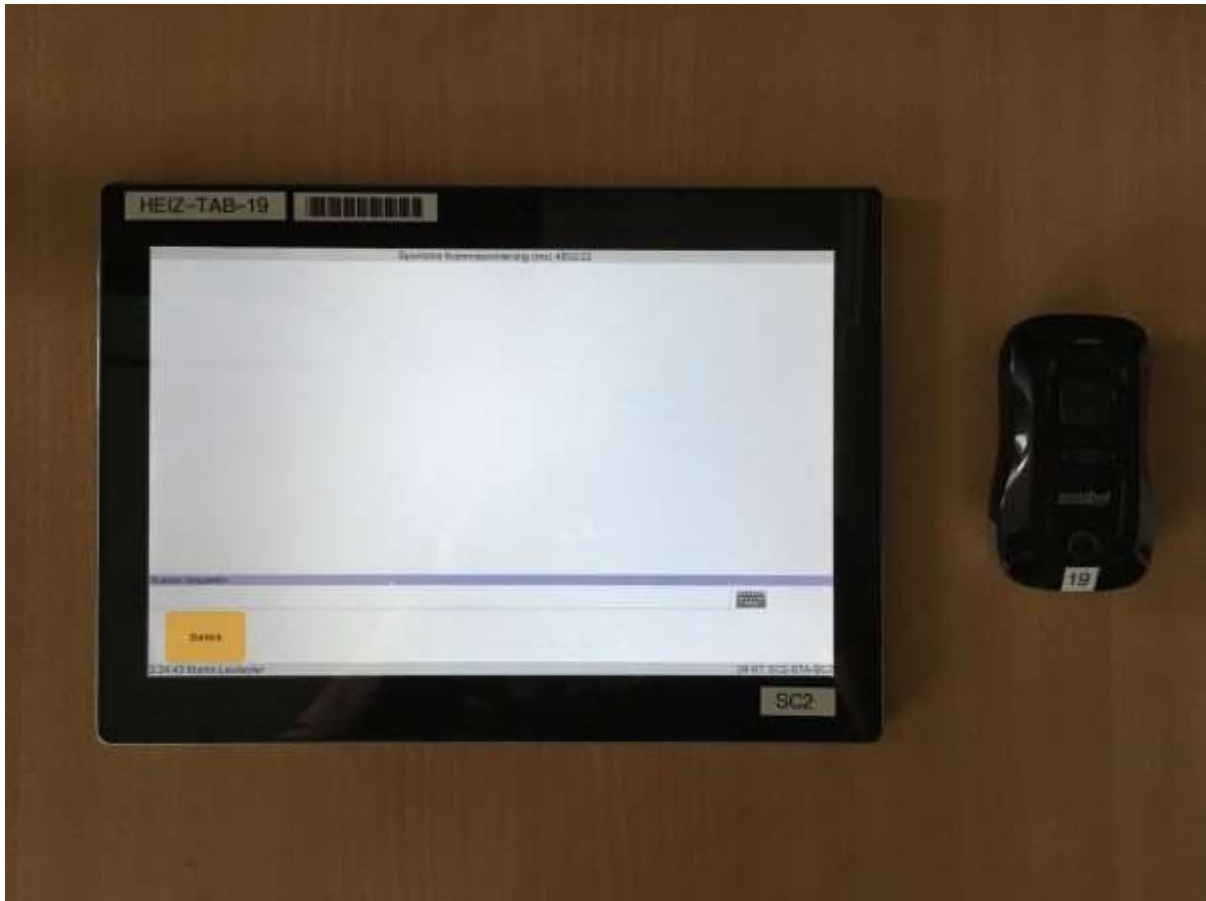
Abbildung 3: Spontane Kommissionierung von Artikeln mit Tablet und Scanner. Die Artikel werden mit dem Scan direkt vom Lagerplatz abgebucht und dem Tablet zugeordnet.
